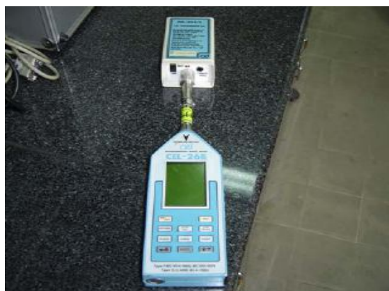
شکل ۳: دستگاه سنجش صدای محیطی در حال کالیبره
