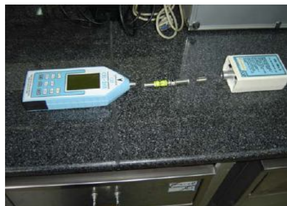
شکل ۲: اجزای دستگاه سنجش صدا به صورت جدا از هم
