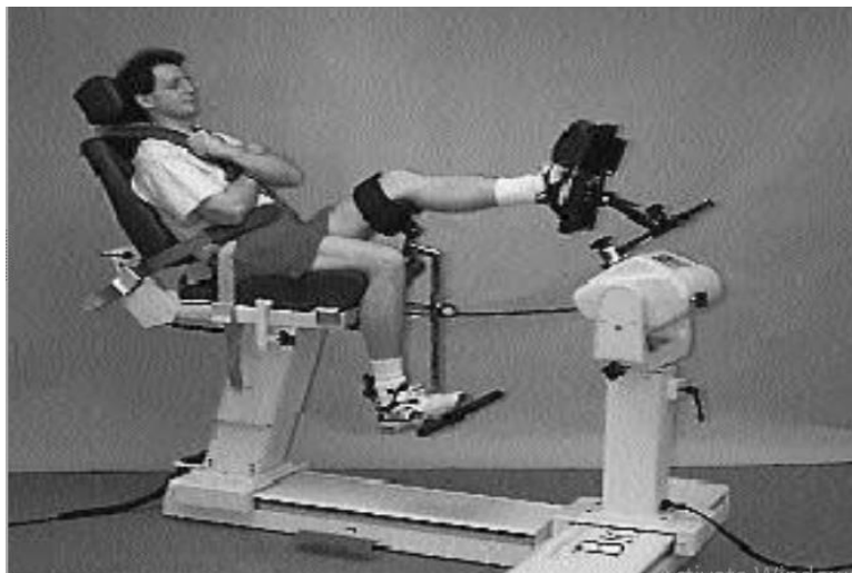
تصویر ۱: ارزیابی قدرت عملکردی عضلات با استفاده از دستگاه ایزوکتیک مدل بایودکس ۳
